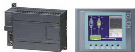
Conservando los estándares de calidad Siemens, lanzamos las nuevas pantallas KTP al mejor precio del mercado. Táctiles, con teclas de funciones y 256 colores TFT. Configurable con WinCC Flexible, sus proyectos pueden ser empleados con otras pantallas SIMATIC. La mejor opción para aplicaciones sencillas.
