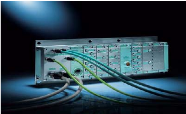
SIMATIC ET 200pro con conexión PROFINET y módulos E/S
